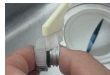
洗浄後は、流水で洗剤分をよく流し、再組み立てを行います。
